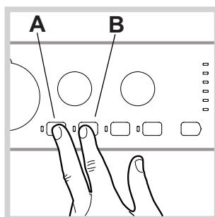
Programı devreye sokmak için 5 saniye boyunca **A** ve **B** tuşlarına aynı anda basınız (*bakınız Şekil*). Program, otomatik olarak başlayacak ve yaklaşık 70 dakika sürecek. Devreyi durdurmak için
