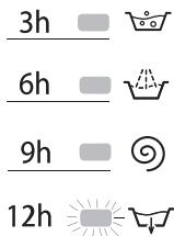
В течение на времето ще се визуализира оставащото забавяне чрез мигане на съответния светлинен индикатор:
