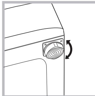
2. Yerleştirilecek zemin tam düz değilse çamaşır makinesinin vidalı ön ayaklarını sıkarak ve gevseterek dengeyi sağlayınız (bkz. şekil); eğim açısı, makinenin üst tezgahına göre  $2^{\circ}$  den fazla olmamalıdır. Sağlıklı bir dengeleme, çamaşır makinesine sağlam bir duruş kazandıracağı gibi, çalışması esnasındaki sarsıntı, gürültü ve hareketlilikleri de önleyecektir. Zeminde moket veya halı olması halinde, ayarı makinenin altında havalandırma olabilecek şekilde yapınız .
