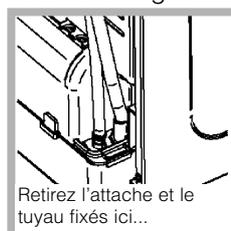
Retirer l'attache existante et le tuyau de la position indiquée (voir schéma).
