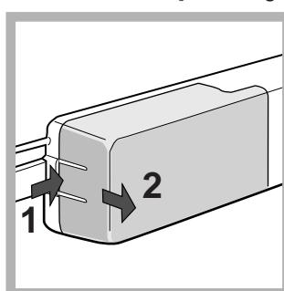
Para obter acesso à lâmpada, retire a protecção da maneira indicada na figura. Substitua-a por uma de potência análoga à indicada na protecção (15 W o 25 W).
