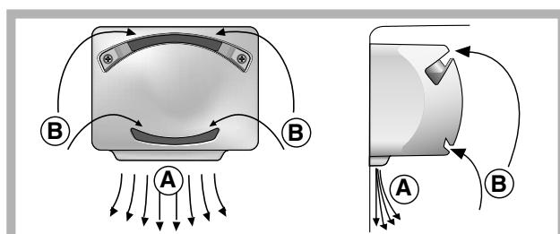
Pure Wind Plus maksymalnie optymalizuje cyrkulację powietrza, zwiększając skuteczność parownika i umożliwiając szybsze osiągnięcie właściwej temperatury wewnętrz lodówki po każdym jej otwarciu. Dmuchane powietrze (A) chłodzi się po zetknięciu z
