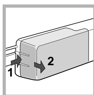
A lámpához úgy fér hozzá, ha az ábrának megfelelő módon leveszi a burkolatot. Cserélje ki a védőburkolaton feltüntetett teljesítményű lámpára (15 W vagy 25 W).
