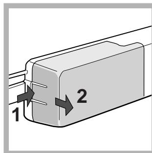
Для замены лампочки освещения в холодильной камере, выньте вилку изделия из электрической розетки. Следуйте инструкциям, описанным ниже. Откройте плафон с лампочкой, сняв плафон, как показано на рисунке.
