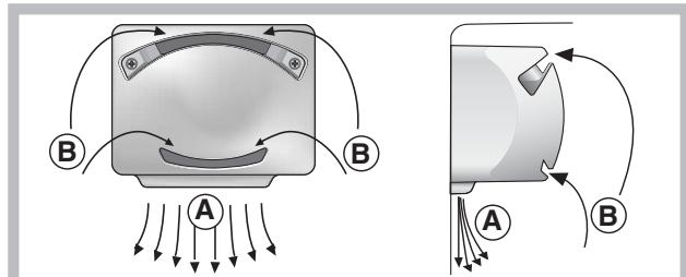
Система PURE WIND PLUS гарантирует отличную сохранность продуктов благодаря быстрому восстановлению заданной температуры после открывания двери и обеспечивает однородную температуру во всей холодильной камере: нагнетаемый воздух (A) охлаждается, поступая в контакт с холодной стенкой камеры, в то время как более теплый воздух (B) высасывается из камеры (см. рисунок).
