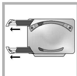
A szűrőkre rárakódott szennyeződés eltávolítása érdekében rendszeres időszakonként (12–18 havonta) mossa el a szűrőket semleges mosószerrel folyó csapvíz alatt! Visszaszerelésük előtt hagyja jól megszáradni őket.
