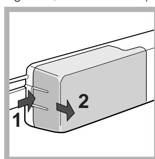
que se dan a continuación. Acceda a la lámpara quitando la protección como se indica en la figura. Sustitúyala con otra bombilla con una potencia igual a la indicada en la protección (15 W o 25 W).
