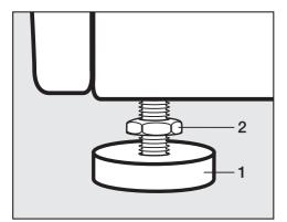
Desserrez le contre-écrou 2 dans le sens des aiguilles d'une montre à l'aide de la clé à fourche fournie. Dévissez le contre-écrou 2 avec le pied 1.
