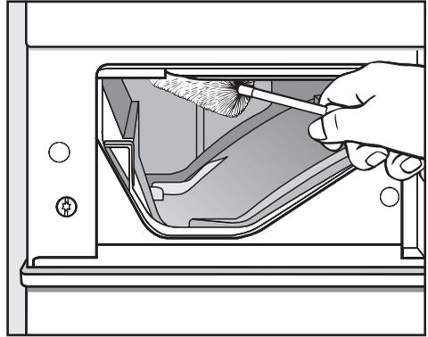
■ Avec un goupillon, enlevez les restes de produit lessivel et le dépôt de tartre des buses d'arrivée d'eau de la boîte à produits.
