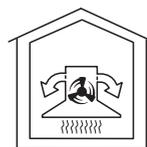
L'air aspiré par la hotte est purifié grâce au filtre à graisses mais aussi grâce à un filtre à charbon actif. Il est ensuite rejeté dans la cuisine.
