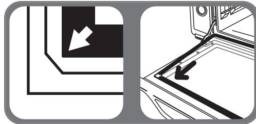
Plaats de binnenuit terug op zijn plaats (markeringen aan de binnenkant van de ovendeur). Let erop om de ruit goed te plaatsen: de **afgeronde hoeken moeten onderaan zijn** (naar het deurscharnier gericht). Plaats de bovenste hoeken het eerst in de gleuven (zie pijlen).
