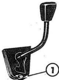
Fig. 17 - Commande de blocage de frein de secours
