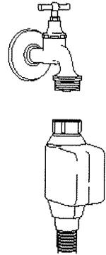
**i** Ausführung 2: Zulaufschlauch mit Aqua Stop System, Wasserzufuhr wird abgesperrt, wenn Undichtigkeiten auftreten sollten; gerätespezifische Ausführung
