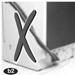
Il est recommandé d'avoir une sortie fixe d'écoulement à environ 25 – 100 cm de distance du sol. Faites en sorte que le tuyau de vidange ne soit pas trop serré, ne fasse pas de plis ou ne forme pas d'étranglements.
