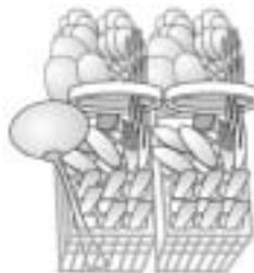
**d** Dans le **panier supérieur**, sont placées les pièces les plus délicates telles que des tasses, des verres, des pièces en porcelaine, ou en verre, et des assiettes de taille standard. Il y a une zone réservée aux longs couverts. De plus, il y a des supports qui, en position verticale, servent à mettre en place des verres à vin.
