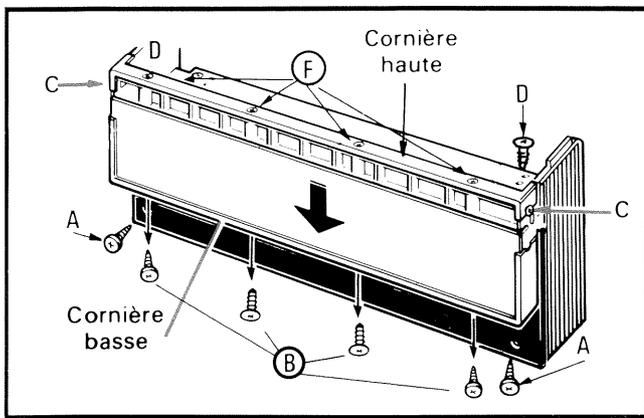
Démontez la plinthe en retirant les 2 vis D.
