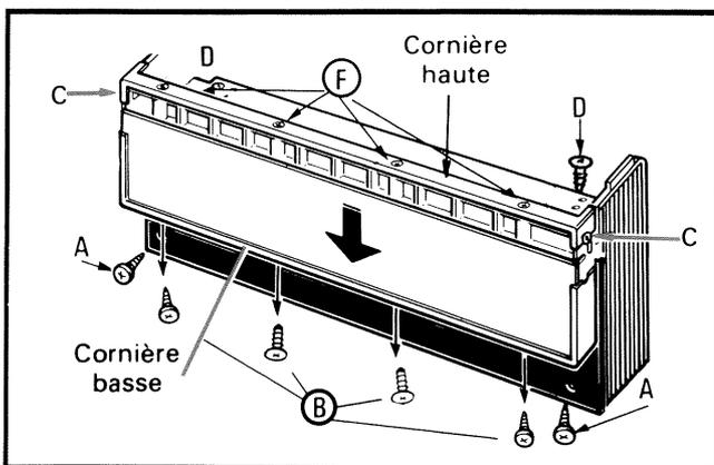
Démonter la plinthe en retirant les 2 vis D.
