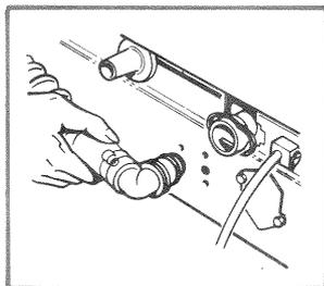
*Le raccord coudé sur lequel est fixé le tuyau de vidange doit être emboîté à fond dans l'embout femelle situé derrière la machine. Cet embout est équipé d'un anneau d'arrêt destiné à éviter un débordement accidentel du raccord coudé ; ce dernier, une fois enclenché peut être orienté dans tous les sens.*
