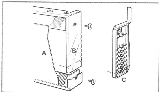
Le panneau inférieur des machines habillables a été conçu de telle façon que sa hauteur puisse être diminuée aisément afin de faciliter son alignement avec les meubles voisins ; il suffit pour cela, après avoir démonté l'ensemble du panneau (2 vis de chaque côté), de désolidariser les pièces qui le composent et de recouper les pièces A, B et C (voir figure) pour les amener à la cote voulue.
