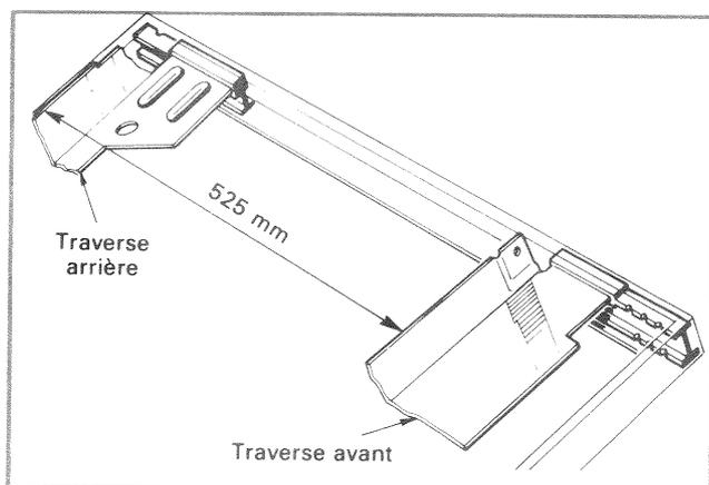
Après ajustage, l'espace laissé libre entre la traverse avant et le chant du dessus peut être comblé par une languette de stratifié glissée entre les embouts et les bords retournés du plan de travail.
