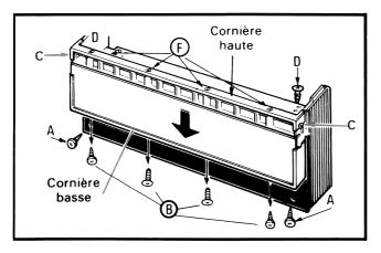
Démonter la plinthe en retirant les 2 vis D.
