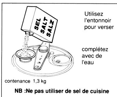
Après le remplissage, effectuez les opérations dans l'ordre inverse pour le remontage. **Important :** bien resserrer le bouchon du réservoir à sel.
