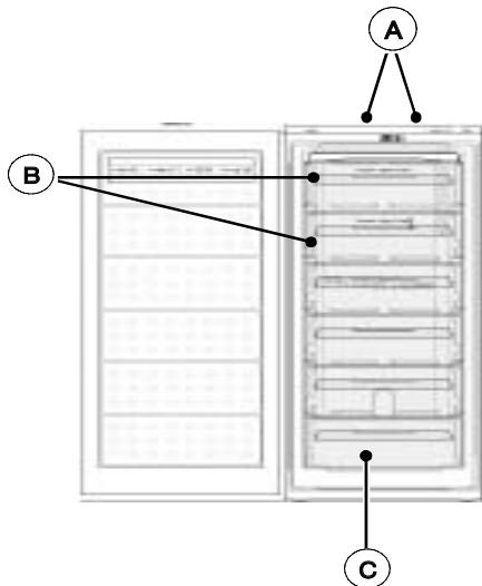
**A** Bedieningspaneel en controlelampje
