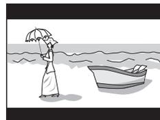
**[4:3 PS] (conversion Pan Scan)** : sélectionner lors du raccordement du lecteur à un téléviseur normal (4:3). Lors de la lecture d'un disque DVD VIDEO enregistré en format image large, l'image est zoomée pour remplir l'écran verticalement, et les côtés droit et gauche de l'image sont coupés.
