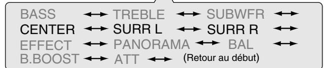
**CENTER\*:** Ajustez le niveau de sortie de l'enceinte centrale (de -10 dB à +10 dB).
