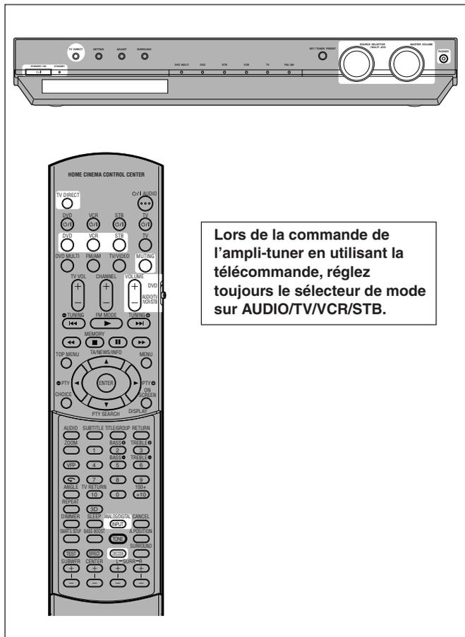
Lors de la commande de l'ampli-tuner en utilisant la télécommande, réglez toujours le sélecteur de mode sur AUDIO/TV/VCR/STB.
