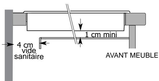
La table peut être encastrée directement dans le plan de travail au dessus du four en position haute. (distance minimum 10 mm)
