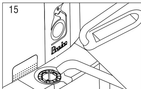
Remettre le bouchon dans son siège et fermer le réservoir en s'assurant qu'il est arrivé en fin de course. Le trou du réservoir est pourvu d'un filtre résille nécessaire à empêcher l'introduction accidentelle de corps étrangers ; il est possible d'enlever ce filtre en le dévissant pour le nettoyer sous un jet d'eau courante.
