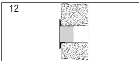
dans le mur : nous vous conseillons d'isoler la section du mur avec du matériau isolant approprié
