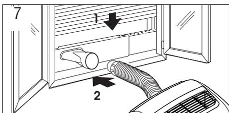
**i** Limiter le plus possible la longueur et les coudes du tuyau d'air et éviter les étranglements.
