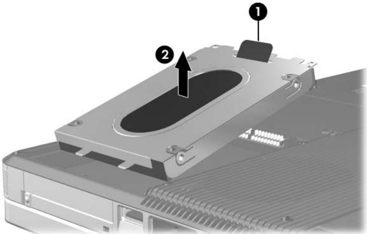
5. Pour insérer le disque dur de remplacement, inclinez le bord avec connecteurs **1** vers le bas, puis reposez le disque dur sur le compartiment jusqu'à ce qu'il soit en place **2**.
