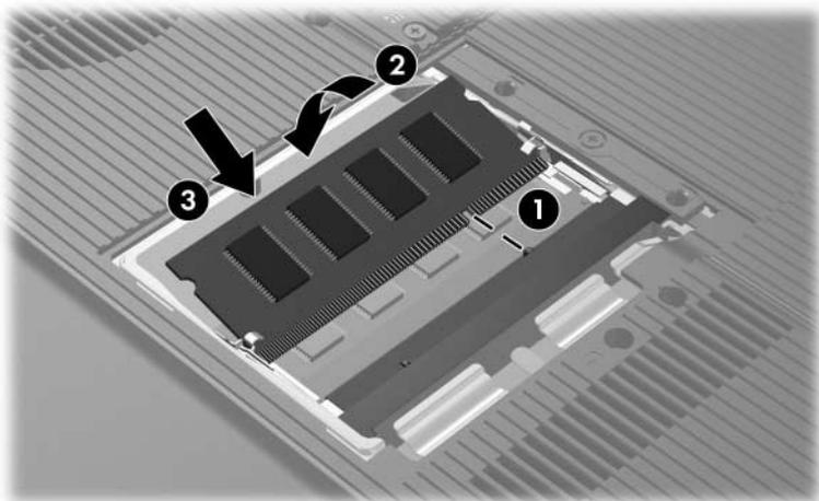
9. Pour fermer le compartiment mémoire, alignez les deux taquets de son cache avec les fentes du portable, puis faites coulisser le cache sur le compartiment mémoire jusqu'à ce qu'il soit en place ❶.
