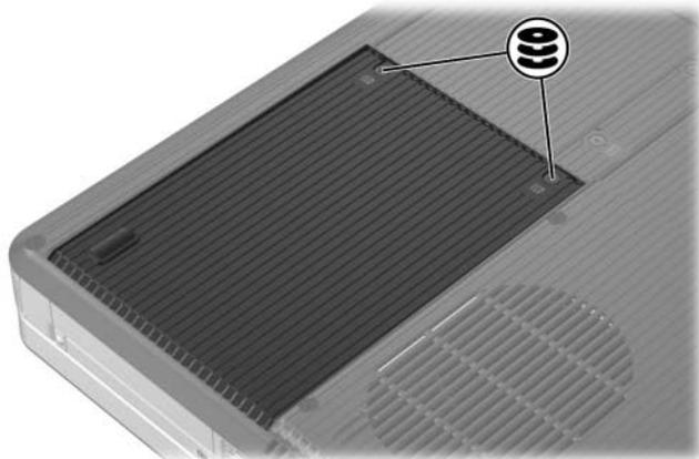
3. Pour retirer le cache du disque dur et accéder au taquet, soulevez-le ❶, puis démontez-le du portable ❷.
