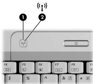
Outre le bouton et les voyants des périphériques sans fil, le portable sans fil peut inclure des commandes logicielles qui permettent d'allumer, d'éteindre, d'activer et de désactiver les périphériques sans fil (voir le tableau ci-dessous).
