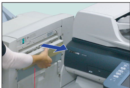
Bac de résidus de la perforatrice (Plein)
