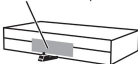
Si nécessaire, utiliser le ruban adhésif à double face (fourni) pour fixer l'émetteur infrarouge sur une surface plane.
