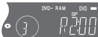
**4 Appuyez sur [REC MODE] pour sélectionner le mode d'enregistrement.**
