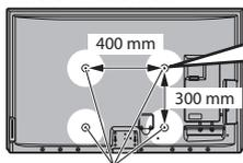
**Profondeur de vissage : minimum 10 mm, maximum 16 mm**
