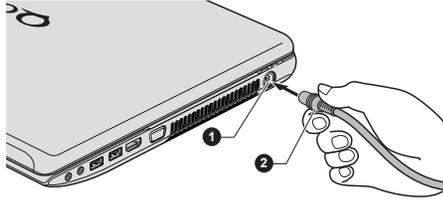
1. Prise entrée adaptateur 19 V      2. Prise de sortie c.c. de l'adaptateur
