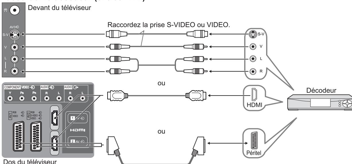
■ Raccorder un magnétoscope/enregistreur DVD et un décodeur (exemple)
