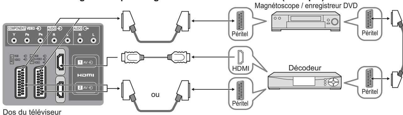
■ Raccorder un enregistreur DVD et un magnétoscope (exemple)
