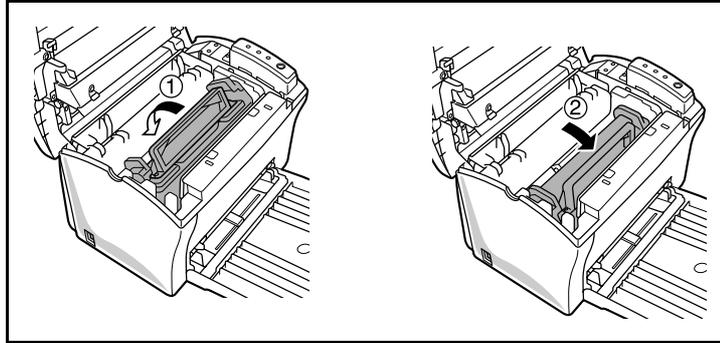
9 - Refermez le capot supérieur en appuyant doucement mais fermement sur celui-ci jusqu'à ce qu'il se verrouille en position.
