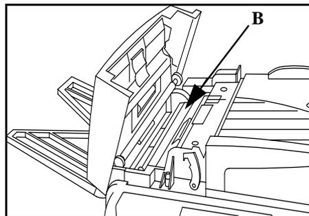
☞ Nettoyez la vitre transparente d'analyse (B) avec un chiffon doux non pelucheux imbibé d'alcool
