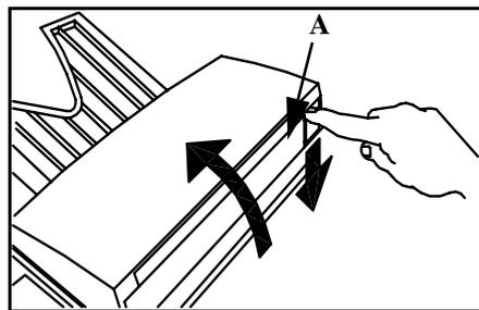
☞ Ouvrez le capot analyse du scanner à défilement en appuyant sur le bouton d'ouverture (A).
