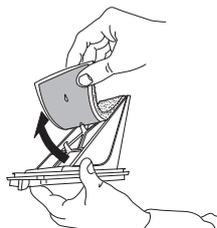
Fixez la mousse de filtre sur le filtre inférieur. Nettoyez la chambre du filtre du sèche-linge avec un chiffon humide ou minutieusement avec un aspirateur. Réinsérez le filtre inférieur. Refermez la poignée de filtre et fermez le volet inférieur.
