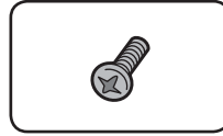
Schroeven M4 x 12 (8) (Deze worden gebruikt voor bevestiging van de bovenste en onderste kast.)
