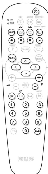
Druk op de toets **MODE** om de gewenste modus te selecteren: **VCR** (videorecorder) of **TV**. Het controlelampje van de afstandsbediening licht op om aan te tonen welke modus werd geselecteerd. Dit gebeurt automatisch wanneer er 20 seconden lang niets gebeurt (terug naar TV-modus).
