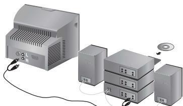
Gebruik een digitale audio-verbindingskabel en sluit de uitgang "DIGITAL AUDIO OUT" van het televisietoestel aan op een "DIG IN"-ingang van de versterker (versterker met digitale coaxialgang).
