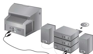
Utilizzare un cavo di collegamento audio digitale e collegare l'uscita "DIGITAL AUDIO OUT" del televisore ad un ingresso "DIG IN" dell'amplificatore (amplificatore con ingresso digitale coassiale).
