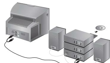
Verwenden Sie ein digitales Audio-Verbindungskabel und schließen Sie den Ausgang "DIGITAL AUDIO OUT" des Fernsehgerätes an einen "DIG IN-Eingang" des Verstärkers an (Verstärker mit digitalem Koaxialeingang).
