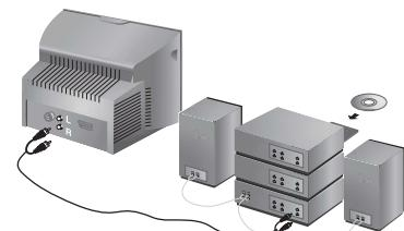
Χρησιμοποιήστε ένα καλώδιο ψηφιακής σύνδεσης ήχου και συνδέστε την έξοδο "DIGITAL AUDIO OUT" της τηλεόρασης με την είσοδο "DIG IN" του ενισχυτή (ενισχυτής με ψηφιακή ομοαξονική είσοδο).
