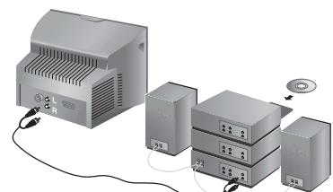
Utilisez un cordon de liaison audio numérique et connectez la sortie "DIGITAL AUDIO OUT" du téléviseur à une entrée "DIG IN" de l'amplificateur (amplificateur avec entrée numérique coaxiale).
