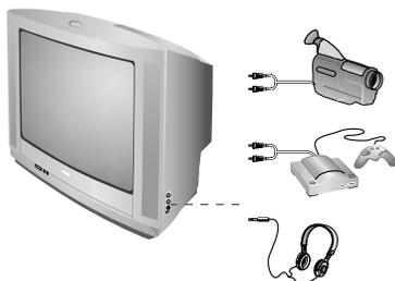
Podłącz urządzenia w sposób pokazany na schemacie. Za pomocą przycisku AV, wybierz AV.
