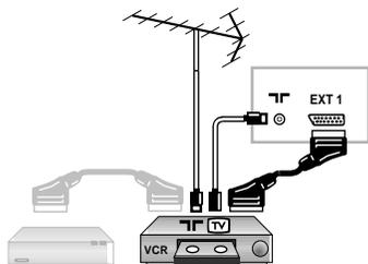
A mellékelt ábra szerint kösse össze a képmagnót a televízióval. Használjon jó minőségű EURO-csatlakozószinórt. Ha a képmagnón nincs EURO-csatlakozó, a televízióval való összeköttetés csak az antennaszinóron keresztül valósítható meg. A televízió 0-ás programját a képmagnó tesztjére kell hangolni (lásd a TÁROLÁS fejezetet, 6. old.). A képmagnó képernyő megjelenítéséhez nyomja meg a **0** gombot.
