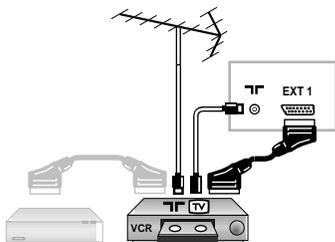
Vykonajte zapojenia uvedené oproti. Používajte kvalitný eurokonektorový kábel.
