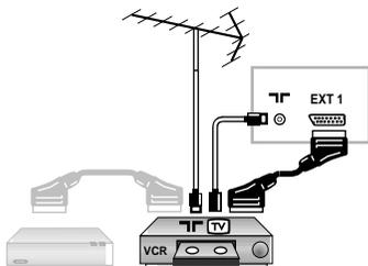
Осуществите указанные на рисунке подключения. Используйте шнур **ПЕРИТЕЛЬ** (SCART) хорошего качества. Если у вашего видеомагнитофона нет разъема перитель (или если этот разъем уже занят другой аппаратурой), то возможна лишь связь через кабель антенны.
