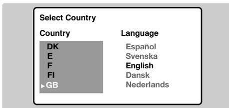
Pokud se menu neobjeví, držte pro jeho vyvolání po dobu 5 sekund stisknutá tlačítka  $\blacktriangleleft$  + a  $\blacktriangleright$  - na televizoru.
