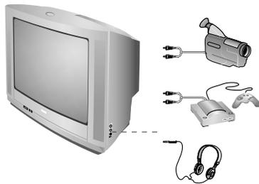
Selon les versions, les prises sont situées à l'avant (parfois sous un volet) ou sur le côté droit du téléviseur. Effectuez les raccordements ci-contre. Avec la touche  $\oplus$ , sélectionner AV.
