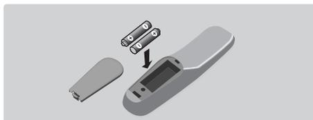
Vložte 2 batérie typu R6 (príbalené), dajte pozor na správnu polaritu.
