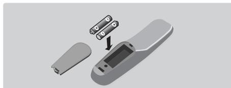
Вставить обе поставляемые с аппаратом батарейки типа R6, в соответствии с указанным направлением установки. Удостоверьтесь, что селектор режима установлен в положение TV. Батарейки, поставленные вместе с аппаратом, не содержат ни ртути, ни кадмия, ни никеля в заботе об охране окружающей среды. Просьба не выбрасывать отработавшие батарейки, а использовать имеющиеся в вашем распоряжении средства их сбора для утилизации (обратиться к вашему продавцу).
