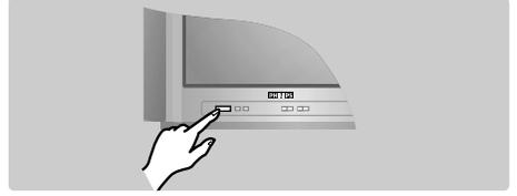
Televizyonunuzu açmak için, açma-kapama tuşuna basınız. Kırmızı gösterge lambası yanar ve ekran aydınlanır. Doğrudan 4 sayfadaki kanalların hızlı ayarlanması bölümüne geçiniz. Eğer televizyon standby (bekleme) modunda kalırsa, uzaktan kumandanın P (+) tuşuna basınız. Uzaktan kumandayı kullandığınızda gösterge lambası yanıp söner.
