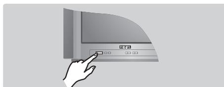
Нажать на клавишу вкл./выкл. для включения телевизора. Загорается красный световой индикатор, и экран загорается. Обратитесь непосредственно к главе быстрой установки на следующей странице. Если телевизор находится в дежурном состоянии, нажать на клавишу P (+) пульта дистанционного управления. При использовании пульта дистанционного управления световой индикатор мигает.
