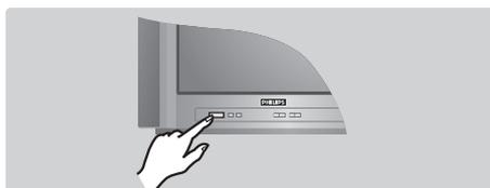
TV prijímač zapnite stlačením hlavného vypínača. Rozsvieti sa červená kontrolka a obrazovka sa rozsvieti. Prejdite priamo do kapitoly rýchla inštalácia na nasledujúcej stránke. Ak televízor zostáva v pohotovostnom režime, stlačte tlačidlo P (+) na diaľkovom ovládači. Pri použití diaľkového ovládača kontrolka bliká.
