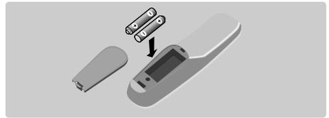
Włóż 2 załączone baterie R6, właściwie ukierunkowując bieguny. Sprawdź, czy przełącznik trybu jest ustawiony w pozycji TV. Ze względu na ochronę środowiska naturalnego baterie dostarczane wraz z odbiornikiem nie zawierają rtęci, kadmu ani niklu. Prosimy, by nie wyrzucać zużytych baterii, ale oddać je do recyklingu (w tym celu skontaktuj się ze sprzedawcą). Zużyte baterie należy zastąpić bateriami tego samego typu.
