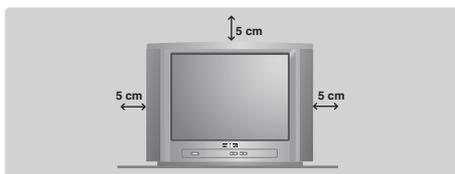
Umiestnite televízor na pevnú a stabilnú plochu a ponechajte aspoň 5 cm voľných okolo prijímača. Aby ste sa vyhlí nebezpečným situáciám, nič na TV prijímač neukladajte, ani pokrývky (obrásky), ani nádobu s tekutinou (vázu) či prístroj vydávajúci teplo (lampu). Ďalej TV prijímač nesmie byť vystavený striekajúcej vode.
