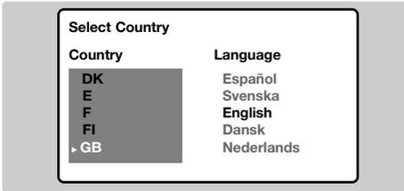
Si le menu n'apparaît pas, maintenez appuyées pendant 5 secondes les touches  $\triangleleft$ - et  $\triangleleft$ + du téléviseur, pour le faire apparaître.
