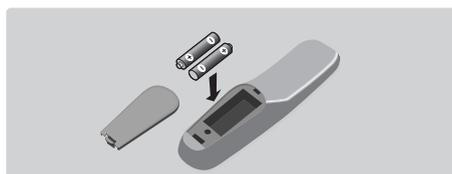
Do ovladače vložte 2 přiložené baterie typu R6, zachovejte polaritu. Zkontrolujte, zda je přepínač režimů v poloze TV.
