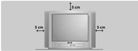
Odbiornik należy umieścić na solidnej, stabilnej podstawie, w odległości co najmniej 5 cm od innych przedmiotów. W celu uniknięcia zagrożenia lub uszkodzenia odbiornika nie wolno na nim umieszczać żadnych przedmiotów, takich jak serwetki, naczynia z płynami (wazony) lub przedmioty wydzielające ciepło (lampy). Ponadto odbiornik nie może być narażony na polanie wodą.
