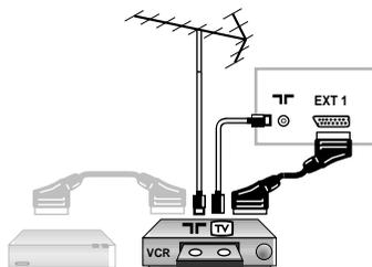
Provedte zapojení znázorněné na obrázku. Použijte kvalitní kabel SCART.
