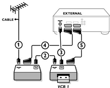
① Branchez les câbles d'antenne ①, ② et ③ tel qu'indiqué (uniquement si votre périphérique dispose d'une entrée/sortie pour antennes TV).
