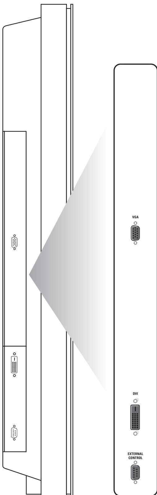
Vous pouvez raccorder jusqu'à 2 sources VGA (**VGA** ou **RVB** Digital (**DVI**)) du côté gauche du moniteur.
