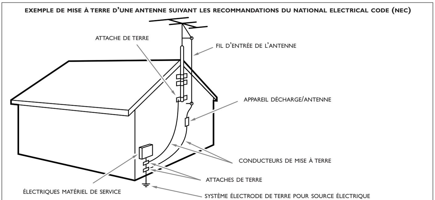
**Note à l'installateur du système câble :** Ce rappel est fourni pour attirer l'attention de l'installateur du système câble à l'Article 820-40 du national Electrical Code qui fournit des conseils pour la bonne mise à terre et, en particulier, spécifie que la terre du câble doit être reliée au système de mise à terre du bâtiment aussi près que possible de l'endroit où le câble y pénètre.
