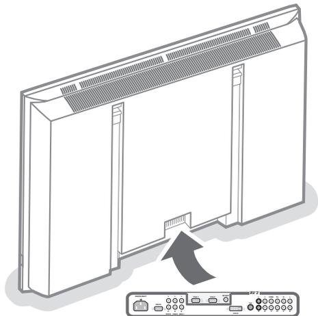
Vous pouvez brancher 3 sources VGA possibles (**VGA1**, **VGA2** ou **DVI-D**) et 3 sources vidéo possibles (**AV1**, **AV2** and **AV3**) au moniteur.
