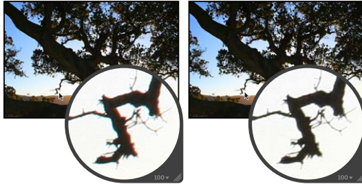
Avant ajustement de l'aberration chromatique Après ajustement de l'aberration chromatique (cyan augmenté)
