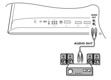
Branchez un récepteur Surround Multicanal analogique aux connecteurs **AUDIO OUT L** et **R** en bas du téléviseur. Le volume doit être réglé via le récepteur Surround Multicanal.
