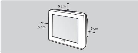
Stellen Sie das Fernsehgerät auf eine stabile Unterlage. Um den Apparat herum sind mindestens 5 cm Platz zu lassen. Um Gefahren und Betriebsstörungen zu vermeiden, dürfen sich auf dem Gerät kein Stoff (z.B. Deckchen), mit Flüssigkeit gefüllte (z.B. Vasen) oder Wärme abstrahlende (z.B. Lampen) Gegenstände befinden. Darüber hinaus darf das Fernsehgerät nicht mit Wasser in Kontakt kommen.
