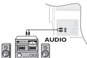
Para conectarse a un sistema hi-fi, utilice un cable de conexión audio y conecte las tomas "L" y "R" de salida de Audio del televisor a la entrada "AUDIO IN" "L" y "R" de su amplificador hi-fi.
