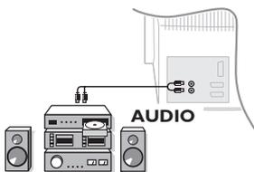
Om TV-apparaten skall anslutas till en hi-fi-anläggning används en ljudkabel. Anslut uttagen « L » och « R » på TV-apparaten till « AUDIO IN » « L » och « R » på hi-fi-anläggningen.
