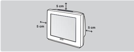
Plaats uw TV toestel op een stevige en stabiele ondergrond en laat rondom het toestel een ruimte vrij van tenminste 5 cm. Om gevaarlijke situaties te voorkomen dient u op het toestel geen voorwerp te zetten dat dekkend (kleedje) of vol met water (vaas) is of dat warmte ontwikkelt (lamp). Het TV toestel mag niet aan water worden blootgesteld.
