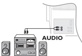
Per il collegamento ad un sistema hi-fi, utilizzare un cordone di collegamento audio e collegare le uscite "L" e "R" del televisore agli ingressi "AUDIO IN" "L" e "R" del vostro amplificatore hi-fi.
