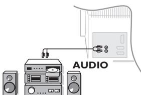
Para efectuar uma ligação a um sistema sonoro de alta fidelidade, utilize um cabo de conexão áudio, e ligue as saídas "L" e "R" do televisor às entradas "AUDIO IN" "L" e "R" do amplificador do seu sistema de alta fidelidade.
