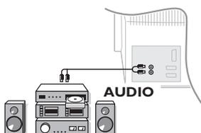
Zum Anschluß an eine HiFi-Anlage benutzen Sie ein Audio-Verbindungskabel. Verbinden Sie die Anschlüsse "L" und "R" des Fernsehgerätes mit einem Eingang "AUDIO IN" "L" und "R" des Verstärkers.
