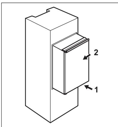
Insérez l'appareil dans le meuble d'encastrement.
