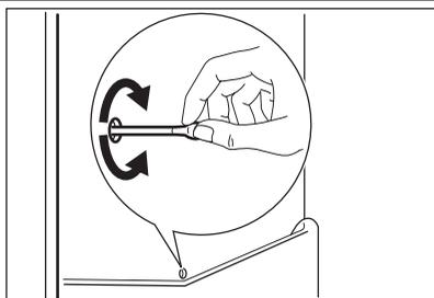
En fonctionnement normal, le givre est automatiquement éliminé de l'évaporateur du compartiment réfrigérateur à chaque fois que le compresseur s'arrête. L'eau de dégivrage est collectée, via un orifice d'évacuation, dans un récipient spécial situé à l'arrière de l'appareil, au-dessus du compresseur, d'où elle s'évapore.
