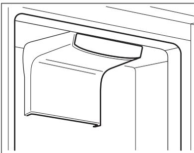
Le compartiment réfrigérateur est équipé d'un dispositif qui permet le refroidissement rapide des aliments et qui maintient une température plus homogène dans le compartiment.
