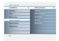
Système: sélectionner Europe (détection automatique\*) ou Europe de l'Ouest (norme BG), Europe de l'Est (norme DK), Royaume-Uni (norme I) ou France (norme LL'). ♠ Mémo. manuel.: appuyer sur >. La recherche débute. Dès que le programme est trouvé, le scannage s'arrête, et le nom du programme s'affiche (lorsqu'il est disponible). Passer à l'étape suivante. Si l'on connaît la fréquence du programme requis, on peut la saisir directement au moyen des touches 0 à 9.
