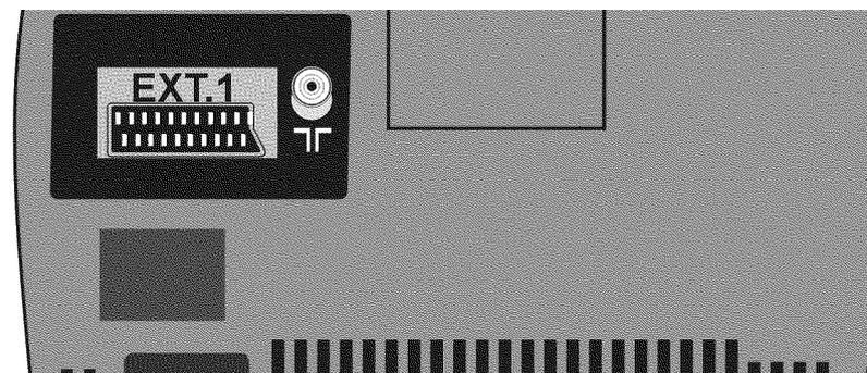
**📡 Prise d'entrée de l'antenne:** prise de raccordement pour l'antenne.
