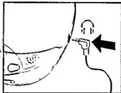
*Remarque: utilisez cette prise pour connecter également votre système Hi-fi (câble de signal) ou votre autoradio (cassette adaptatrice ou câble de signal). Dans les deux cas, le volume sur le lecteur de CD doit être réglé sur la position maximale (10).*
