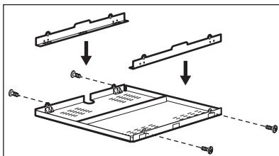
Si vous utilisez une enceinte de protection (accessoire en option **1)**), le fond de protection installé directement sous l'appareil n'est plus nécessaire.
