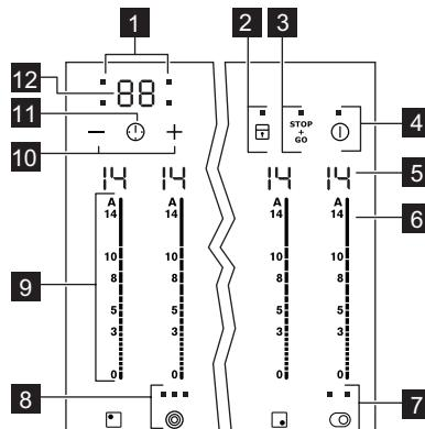
**Gebruik de tiptoetsen om het apparaat te bedienen. De displays, indicatielampjes en geluiden tonen welke functies worden gebruikt.**
