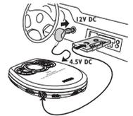
*Remarque : Si votre autoradio possède une prise LINE IN, il est préférable de brancher l'appareil à cette prise plutôt que d'utiliser la cassette-adaptatrice. Branchez LINE OUT/↻ de l'appareil à la prise LINE IN de votre autoradio avec un câble adapté.*
