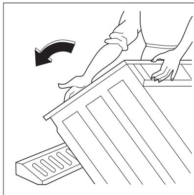
2. Redressez l'appareil et retirez la fixation du câble d'alimentation électrique et du tuyau de vidange placée à l'arrière de l'appareil.
