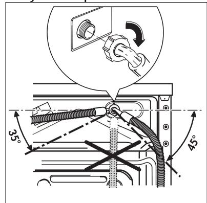
3. Pour ajuster l'orientation du raccord du tuyau d'alimentation, dévissez la bague de serrage placée à l'arrière de l'appareil. Après avoir positionné le tuyau d'alimentation, veillez à revisser correctement la bague de serrage pour éviter toute fuite.
