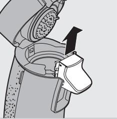
**4** Retirez l'unité d'écoulement du café de l'appareil en la faisant glisser vers le haut.
