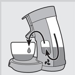
► Durant le cycle de rinçage, la chaudière se remplit avec l'eau du réservoir et de l'eau froide sort de l'unité d'écoulement du café. L'appareil est plus bruyant pendant le cycle de rinçage que pendant le cycle de préparation du café.
