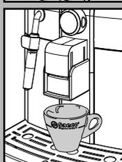
Pour effectuer ce réglage, lever ou baisser le distributeur manuellement plaçant les doigts comme montré dans la figure.
