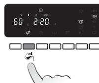
Appuyez sur "Départ (Pause)". La porte se verrouille. Le tambour tourne doucement pendant 10 secondes environ afin de permettre la détection de la charge de linge à laver. Une animation apparaît dans la zone d'affichage. Notez que pour les programmes Laine et Délicat, le tambour tourne encore plus doucement.
