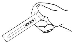
Plongez la bande test dans de l'eau du robinet pendant 1 seconde seulement.
