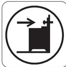
1. Installez la protection anti-bascule à une distance de 232 mm à 237 mm en-dessous de la surface supérieure de l'appareil et à une distance de 110 mm à 115 mm du côté de l'appareil, dans l'orifice circulaire situé sur un support. Vissez-la dans un matériau solide ou utilisez un renfort adapté (mur).
