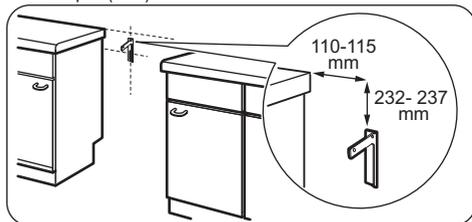
2. L'orifice se trouve sur le côté gauche, à l'arrière de l'appareil. Soulevez l'avant de l'appareil et placez-le au milieu de l'espace entre les placards. Si l'espace entre les placards est supérieur à la largeur de l'appareil, vous devez ajuster la mesure latérale si vous souhaitez centrer l'appareil.
