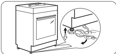
Utilisez les petits pieds situés sous l'appareil pour mettre la surface supérieure de l'appareil de niveau avec les autres surfaces environnantes.
