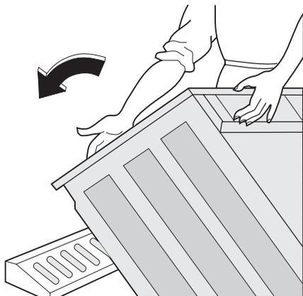
2. Redressez l'appareil et retirez la fixation du câble d'alimentation électrique et du tuyau de vidange placée à l'arrière de l'appareil.
