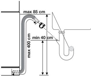
Enlevez le bouchon d'évier lorsque l'appareil évacue l'eau pour empêcher tout reflux de l'eau vers l'appareil.
