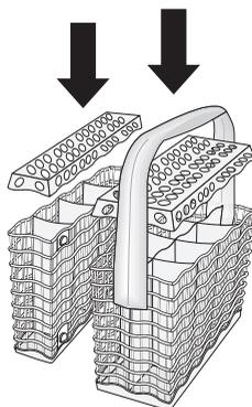
Le panier à couverts est constitué de deux parties. Vous pouvez utiliser ces parties séparément pour faciliter le chargement. Pour séparer les deux parties, faites-les glisser à l'horizontale en direction opposée et détachez-les. Pour assembler les deux parties, placez-les l'une contre l'autre et faites-les glisser l'une vers l'autre horizontalement.
