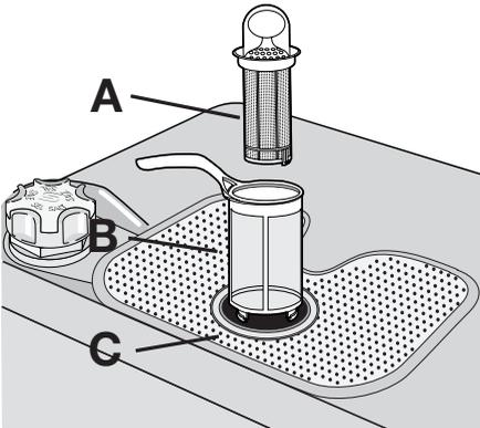
1. Pour déverrouiller le système de filtrage, tournez la poignée du microfiltre (B) d'environ 1/4 de tour vers la gauche. Soulevez le filtre pour le retirer du filtre plat (C).
