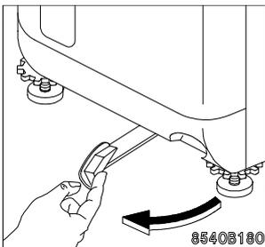
Pour déplacer votre lave-linge, il suffit de le mettre sur ses roulettes en tirant de la droite vers la gauche le levier situé au bas de l'appareil. Une fois la machine placée à l'endroit choisi, ramenez le levier dans sa position initiale.
