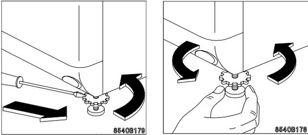
Une mise à niveau précise évite les vibrations, les bruits et les déplacements de la machine durant le fonctionnement. Après la mise à niveau, bloquez les vérins en serrant les bagues manuellement ou à l'aide d'un tourne-vis.
