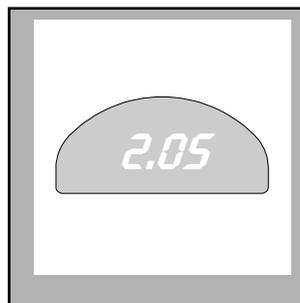
Celle-ci est calculée en fonction de la charge maximale prévue pour chaque type de textile. L'indication du temps de lavage apparaît en heures et minutes dans la fenêtre d'affichage et diminue de minute en minute.
