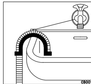
Dans ce cas, il est nécessaire de veiller à ce que l'extrémité ne puisse pas tomber au sol lorsque la machine effectue la vidange. Vous pouvez, par exemple, la fixer avec une petite ficelle au robinet ou l'accrocher au mur.
