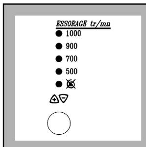
Lors de la sélection du programme, ou en mode pause, le voyant correspondant à la vitesse d'essorage maximum s'allume. Vous pouvez moduler la vitesse d'essorage qui correspond à la nature du linge et au degré d'humidité souhaité en fin de lavage en fonction de
