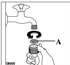
Vissez le raccord du tuyau d'alimentation sur le nez fileté du robinet d'arrivée d'eau (20x27), en ayant soin de bien positionner le joint **A** prévu dans le sachet livré avec l'appareil.
